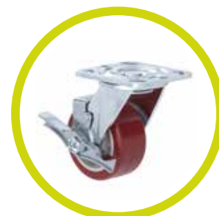
HI101PGSPUMRFM 4" giratoria con placa herraje soldado con rueda de poliuretano con freno tipo mariposa.
