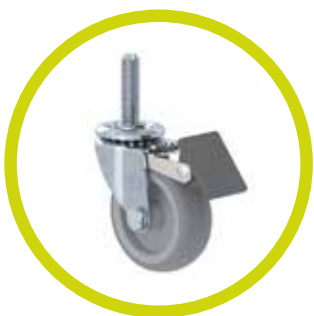
HT646FRHTGA1 2 1/2" giratoria con espiga roscada de \varnothing 7/16" con rueda de hule termoplástico con freno de pedal.
